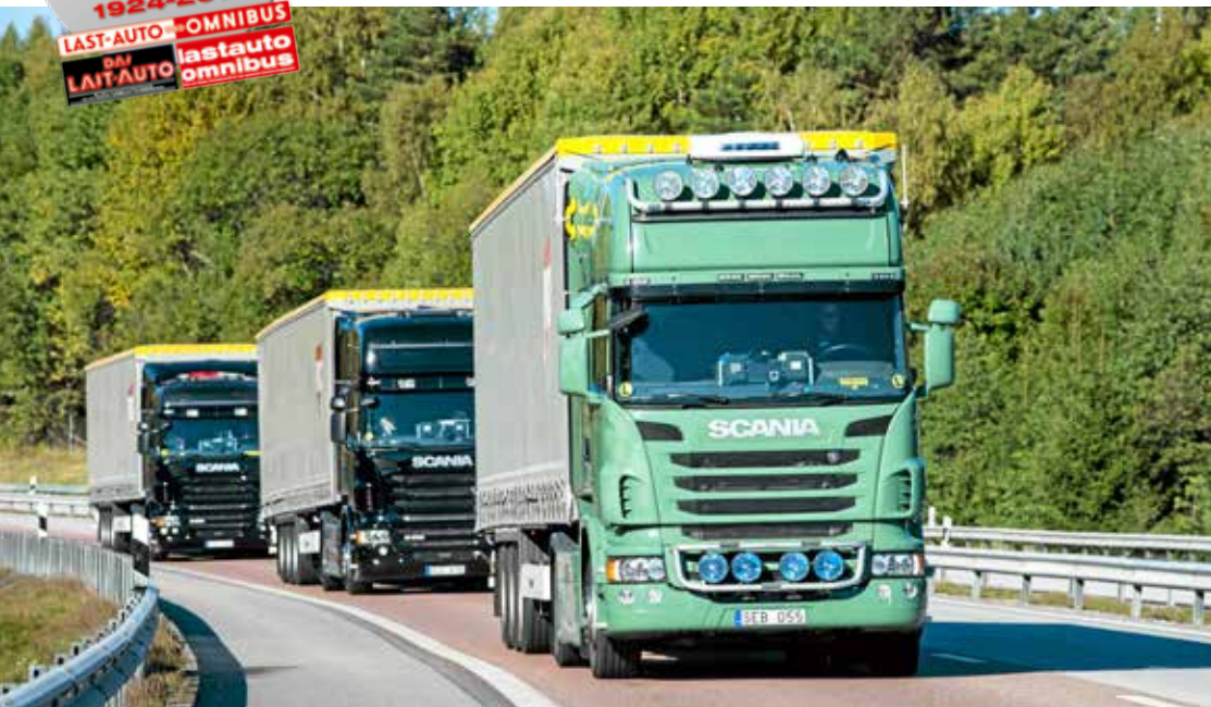
Im Verbund per elektronischer Deichsel: weniger Verbrauch aufgrund günstigerer Aerodynamik.
