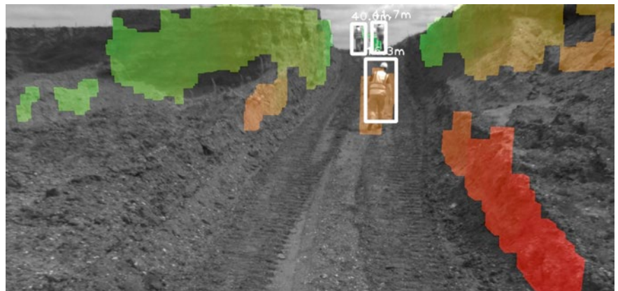
BILD 1 Detektion und farbliche Kennzeichnung von Hindernissen entsprechend ihrer Abstände zur Kamera (grün: weit entfernte Objekte; rot: Objekte im Nahbereich; Fußgänger werden zusätzlich durch einen weißen Rahmen gekennzeichnet) © ITK Engineering
