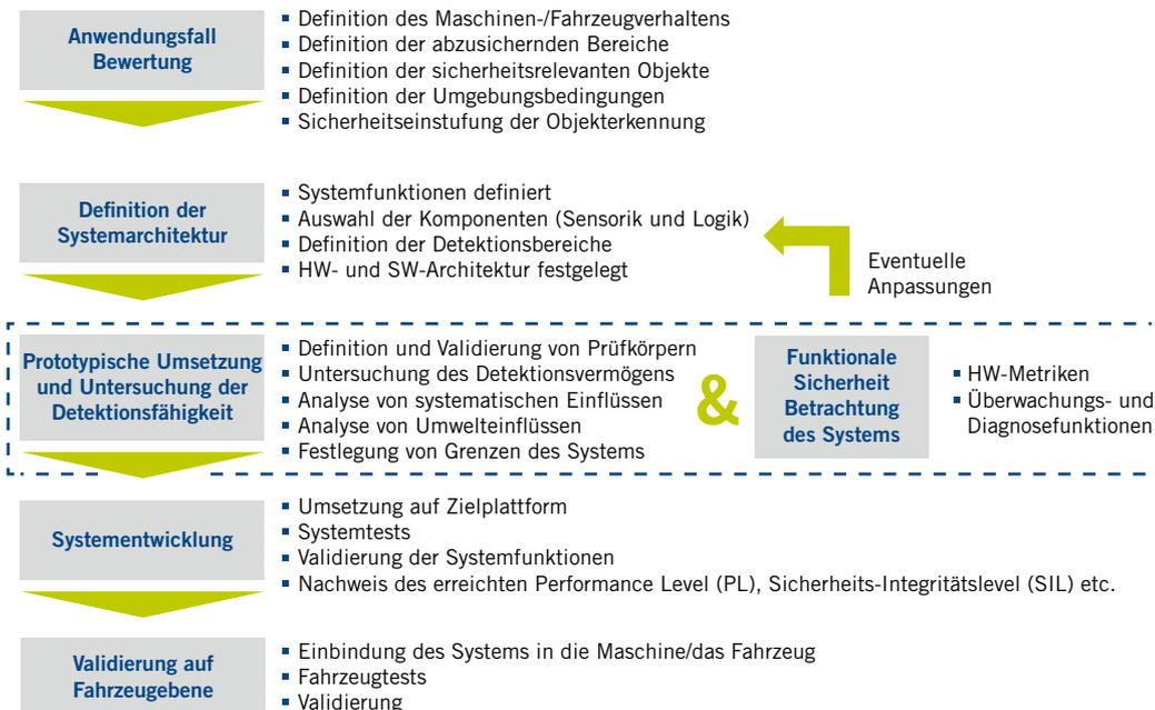
**BILD 1** Entwicklungsprozess einer zuverlässigen Objekterkennung unter Beachtung des Anwendungsszenarios der Maschine (© ITK Engineering)
