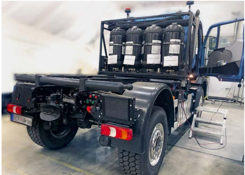
**BILD 4** Integration der vier vertikalen H<sub>2</sub>-Drucktanks im Aufbau des straßengebundenen Fahrzeugs Unimog (© Daimler Truck AG)
