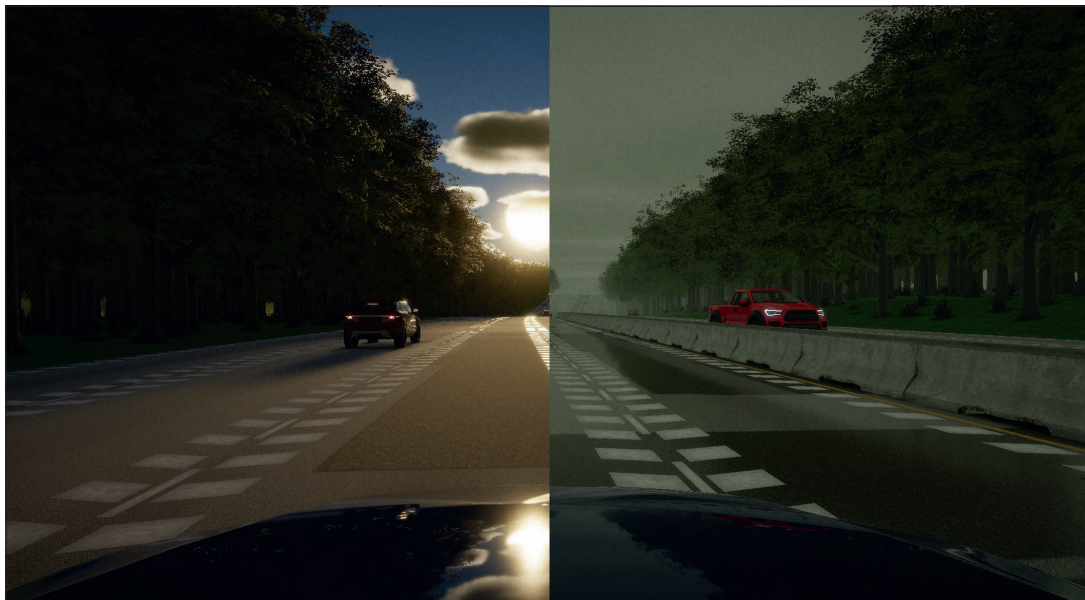
Bild 1: Synthetisch erzeugtes Szenario mit japanischen Fahrbahnmarkierungen bei unterschiedlichen Wetterbedingungen.
